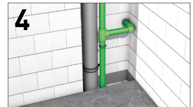
Instalación de la pata de muelle
