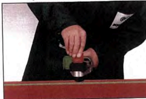
Podgrzanie spajanych elementów
