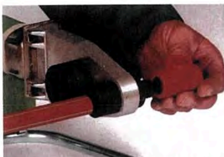
Ogrzewanie elementów (rury i trójnika)
