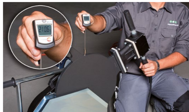
Temperaturmessung an aquatherm Stumpfschweißmaschine
