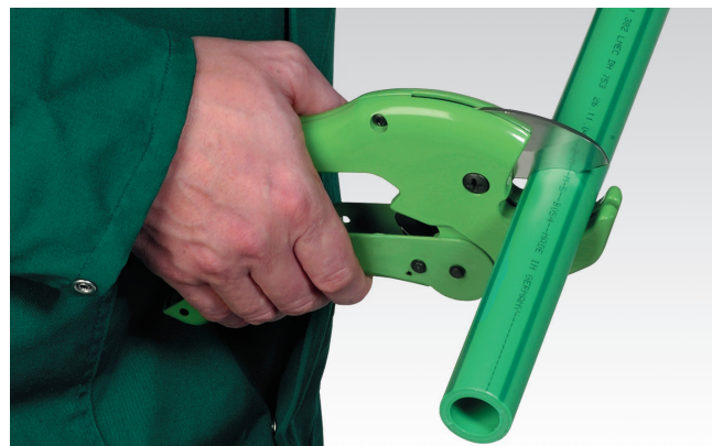
Cortar la tubería
