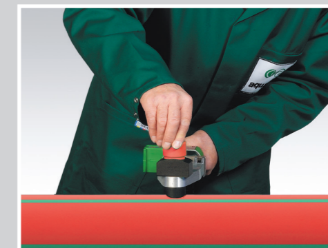
2. Calentar derivación y tubo de forma simultánea (30 seg.)
