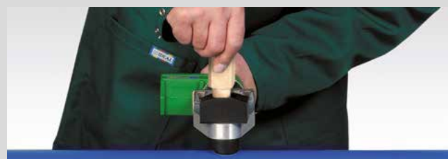
La matriz del soldador es insertada dentro del tubo ...
