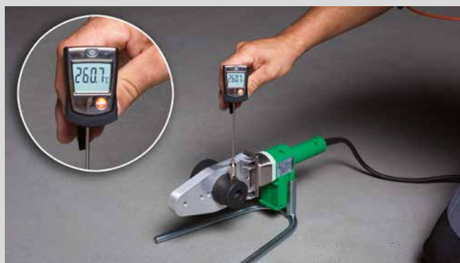
Medición de la temperatura en soldador (800W )
