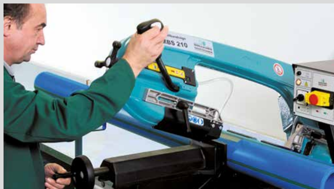
Antes de la soldadura se corta el tubo hasta la longitud deseada
